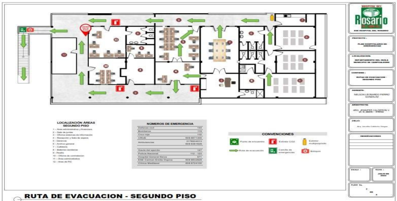
Fotografía 9: Plano de Evacuación Segundo Piso
